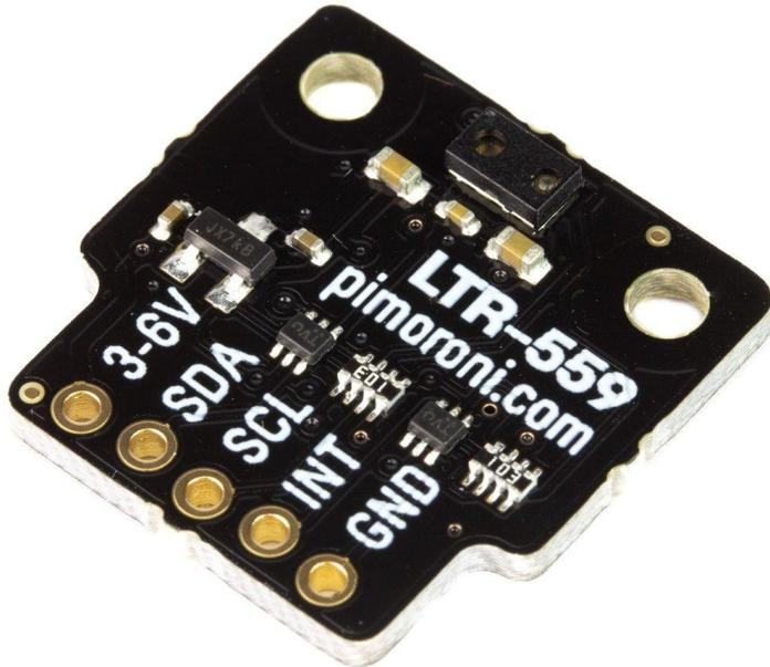
Dieser Licht- und Näherungssensor erkennt Licht über einen großen dynamischen Bereich (0,01 Lux bis 64.000 Lux) und Nähe innerhalb einer kurzen Reichweite von ~5cm.
