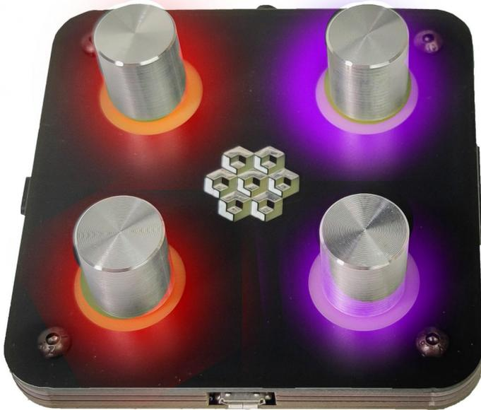
Mit dem Moduknob können Sie 4 Endlos-Push-Encoder mit Farbrückmeldung bedienen. Er sendet Midi-Signale und Sie können jeden einzelnen nach Belieben anpassen. Er ist perfekt, um Effekte an Ihren Synthesizern, VST oder DAW zu steuern.
