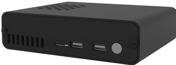
Dieses Gehäuse im NUC-Stil aus Aluminiumlegierung bietet besseren Schutz und verfügt über ausgezeichnete Kühlung mit dem eingebauten ICE-Tower Cooler und sorgfältig ausgeschnittenen Lüftungsöffnungen. Der PWM-Lüfter des ICE-Tower Cooler unterstützt eine einstellbare Temperatur- und Drehzahlregelung des Lüfters. Obwohl das Gehäuse aus Aluminium gefertigt ist, sind die Front- und Rückplatten aus Acryl, um eine gute WLAN-Signalstärke zu gewährleisten.
