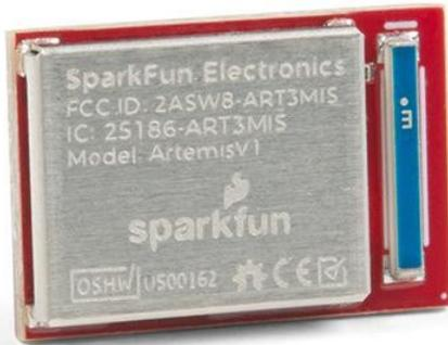
Das Artemis Modul von SparkFun ist ein Cortex-M4F mit BLE 5.0, der mit bis zu 96MHz und einem Stromverbrauch von nur 6uA pro MHz (weniger als 5mW) arbeitet. Dies ist das weltweit erste Modul, das eine Brücke zwischen Hobbyisten und Consumer-Produkten schlägt. Wir haben die gesamte Leistung eines modernen Mikrocontrollers in ein Modul gepackt, das sowohl extrem einfach zu bedienen als auch massenmarktauglich ist.
