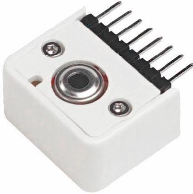
**NCIR HAT** ist ein M5StickC kompatibler Infrarotsensor. Genau wie die M5Unit NCIR integriert dieses Stickc HAT Modul den MLX90614, der zur Messung der Oberflächentemperatur eines menschlichen Körpers oder eines anderen Objekts verwendet werden kann. Mit dem Gehäuse von stickc HAT können Sie nun so ziemlich alle Implementierungen auf stickc-basierte Controller verlagern, die sich durch Winzigkeit, geringe Kosten und hohe Produktivität auszeichnen.
