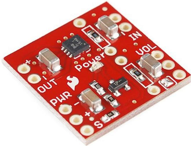
Dieser kleine Audioverstärker basiert auf dem TPA2005D1 von Texas Instruments. Sein effizienter Class-D-Betrieb sorgt für geringe Wärmeentwicklung und lange Batterielebensdauer. Er kann einen 8-Ohm-Lautsprecher mit bis zu 1,4 Watt ansteuern; er wird zwar kein Stadion zum Beben bringen, aber er wird reichlich Lautstärke für Ihre Audioprojekte liefern.
