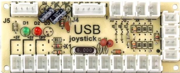
Der Zero Delay Encoder bietet auf einfache Weise die Möglichkeit eigene Arcade-Buttons oder ein Joystick anzuschließen und mit einem PC oder Raspberry Pi zu verbinden. Das Board wird dort einfach als USB Joystick erkannt.
